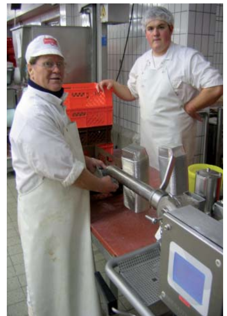
Fleischkäsebrätabfüllung bei Brandenburg nach der Metalluntersuchung durch den Metallseparator P-TRON 05 O
