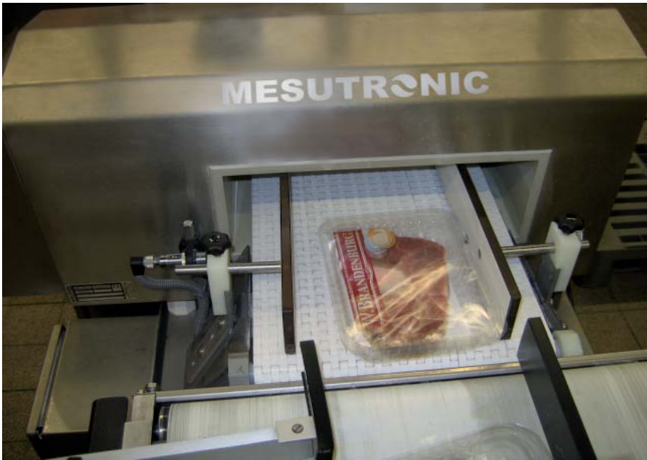
Metallsuchsystem TRANSMETRON 05 CI Touch zur Fleischuntersuchung
