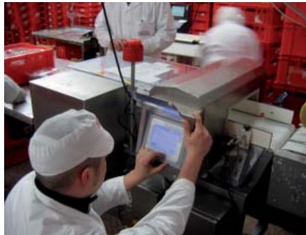
Florian Wettstein führt Einstellungen, am einfach und schnell zu bedienendem Touch-Screen Bedienfeld des Metalldetektors durch.
